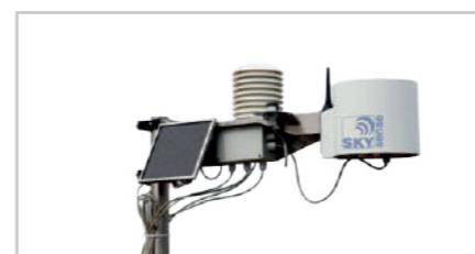
Estación meteorológica autónoma con alimentación mediante panel solar y batería interna. Con conectividad a la nube para su visualización en plataforma de gestión, con lecturas de temperatura, humedad relativa, precipitación, velocidad del viento, evapotranspiración, radiación.
