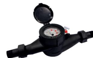
Contadores de agua Gaer® en material polimérico de transmisión magnética, con homologación ICT/I55/2020, sin necesidad de mantener tramos rectos ni antes ni después del contador (UOD0), disponible desde 1/2" hasta 1-1/2", con posibilidad de acoplar emisor de pulsos. PN10.
