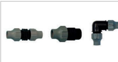
Conectores roscados desmontables, de tuerca loca hembra, fabricados en polipropileno con junta EPDM autoestanca para evitar el uso de teflón, resistentes a productos químicos, PN10. Diámetros 16, 20 y 25 mm.
