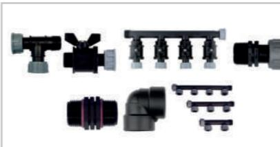
Accesorio roscado y en tuerca loca hembra (TLH) fabricado en polipropileno con junta EPDM autoestanca para evitar el uso de teflón, resistente a productos químicos, PN10. Diámetros desde 1/2" a 2".
