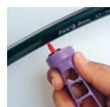
Inserción del Xeri-Bug™ en un solo paso
